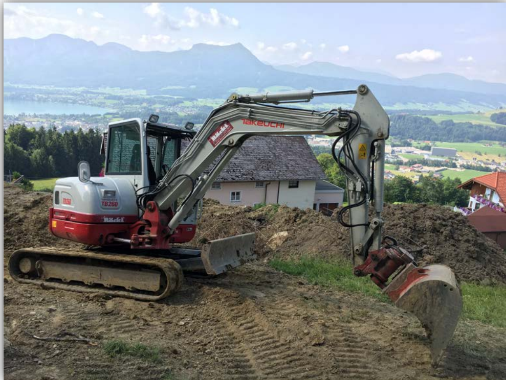
Monoblockausleger Raupentyp: Gummi 400mm – Unterwagen 2m Schnellwechselplatte Martin
